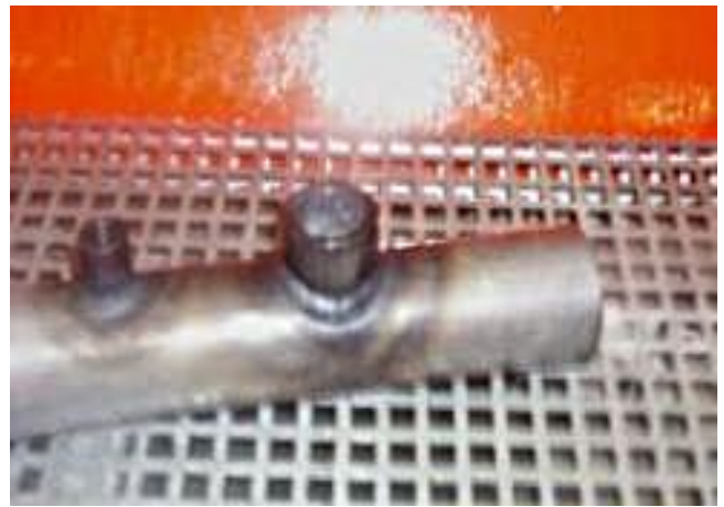
(Rohrkörper während des Spülens)
