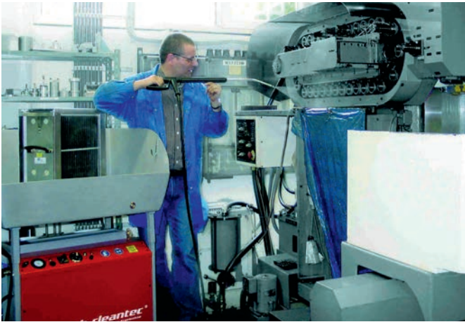
Die Maschinenwartung mit dem Niederdruck-Heißreinigungsverfahren ist effektiv und schonend und ohne Schmutzverteilung in der Halle.
