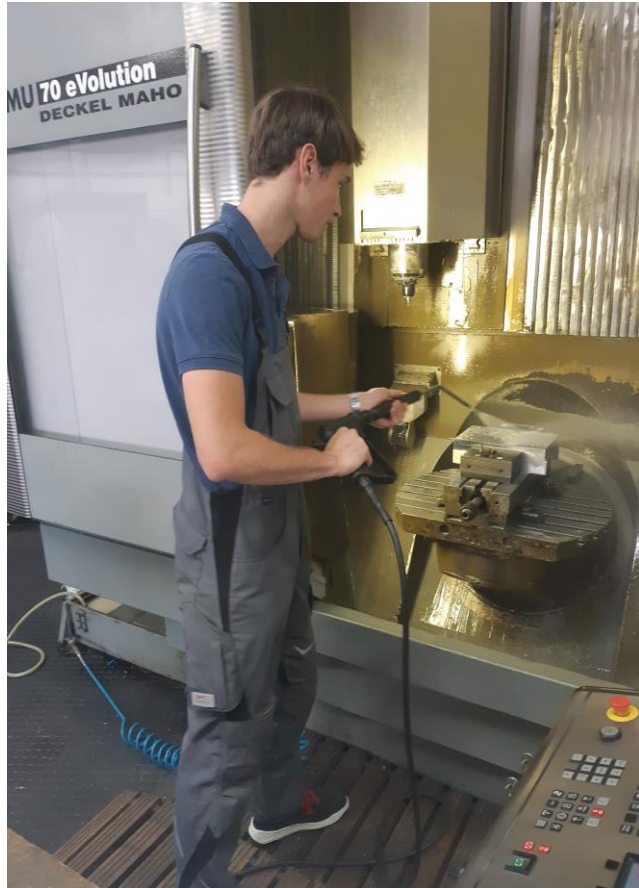
Reinigung mit Niederdruck-Heißreinigungstechnik Werkzeugmaschine mit Schwenktisch
