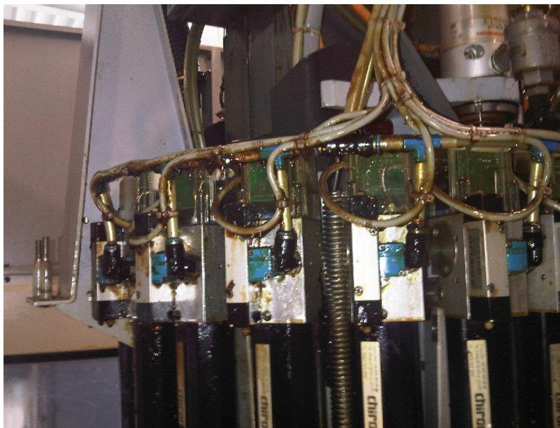
Die mit Öl verschmutzten Werkzeuggreifer erfordern eine besonders schonende Reinigung
