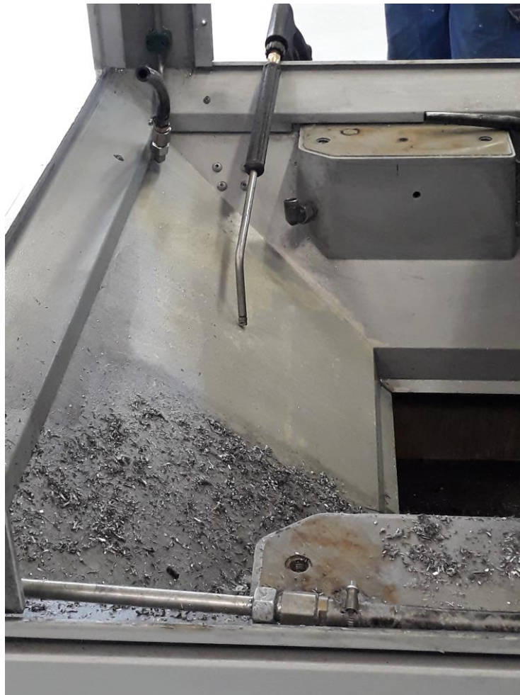
Retrofit einer Werkzeugmaschine – teilweise gereinigt mit Niederdruck-Heißreinigungstechnik
