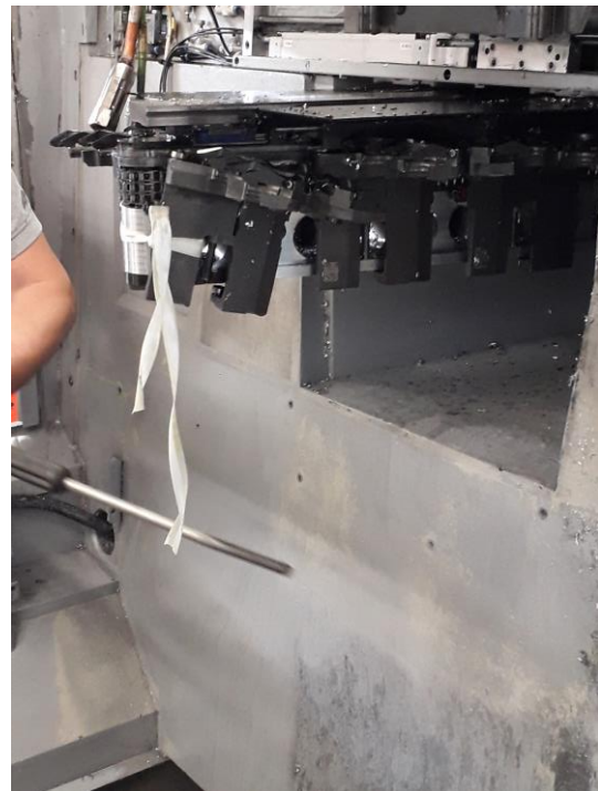
Demontierte Werkzeugmaschine - Reinigung im Rahmen eines Retrofits
