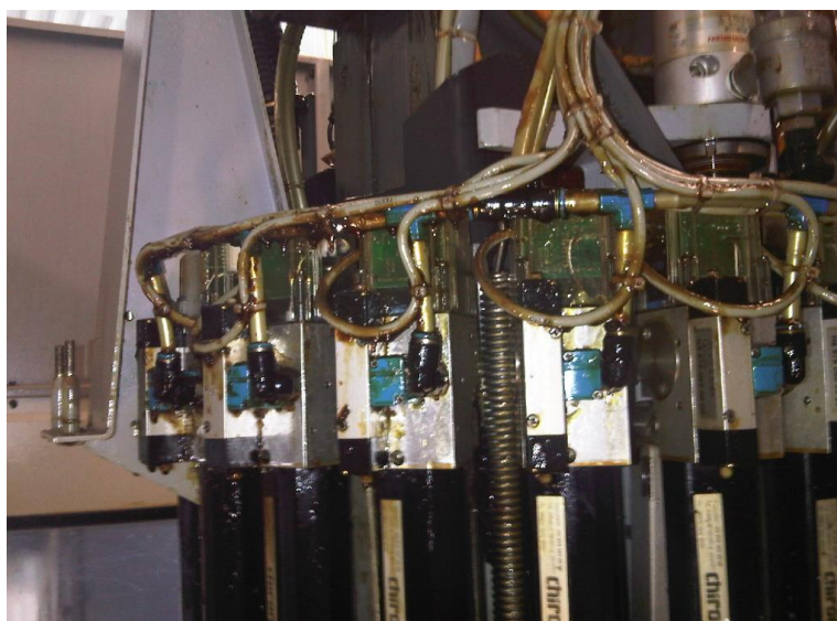
Die mit Öl verschmutzten Werkzeuggreifer erfordern eine schonende Reinigung
