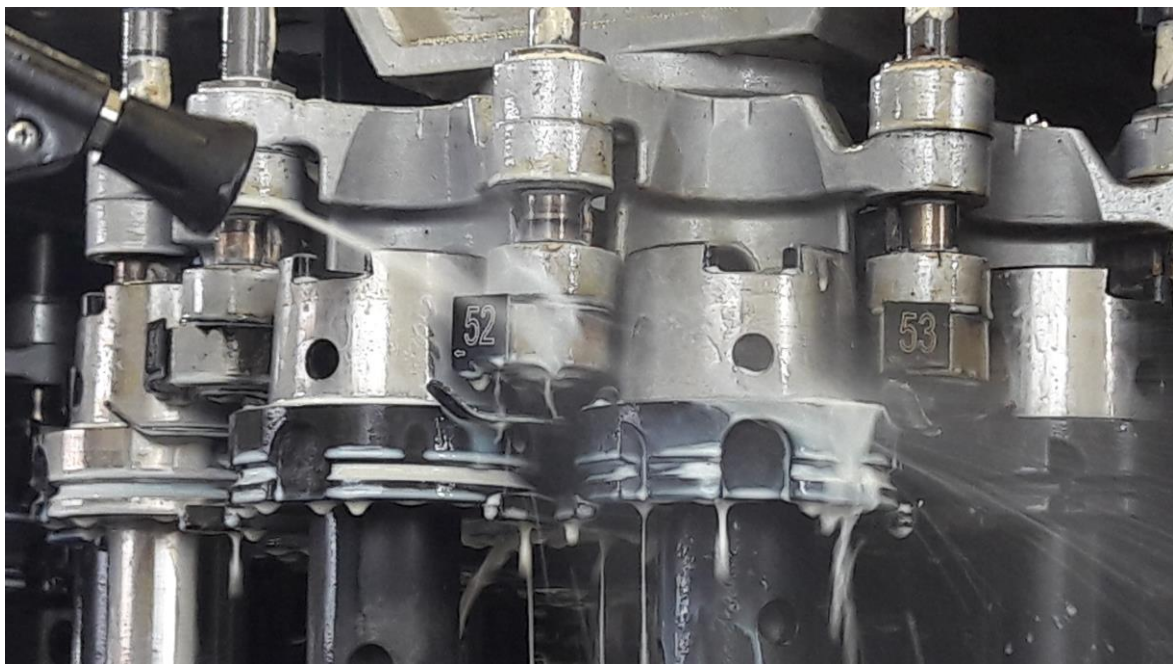
Reinigung eines Teller-Werkzeugmagazins mit Niederdruck-Heißreinigungs-Technik – Detail Werkzeugaufnahme HSK63
