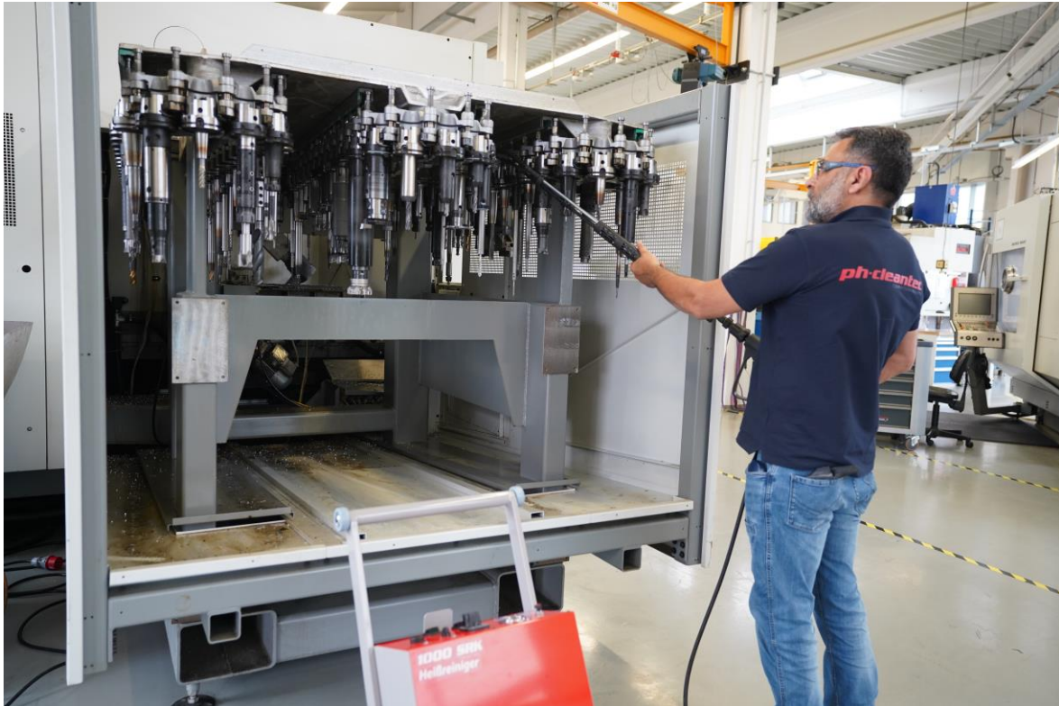
Reinigung eines Werkzeugmagazins mit Niederdruck-Heißreinigungs-Technik - Tellermagazin
