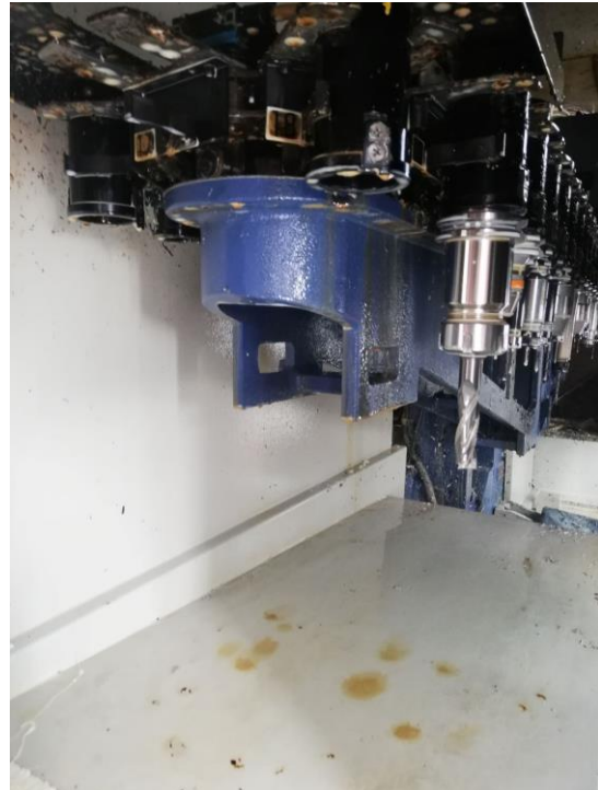
Reinigen eines Werkzeugmagazins mit Niederdruck-Heißreinigungstechnik vorher und nachher
