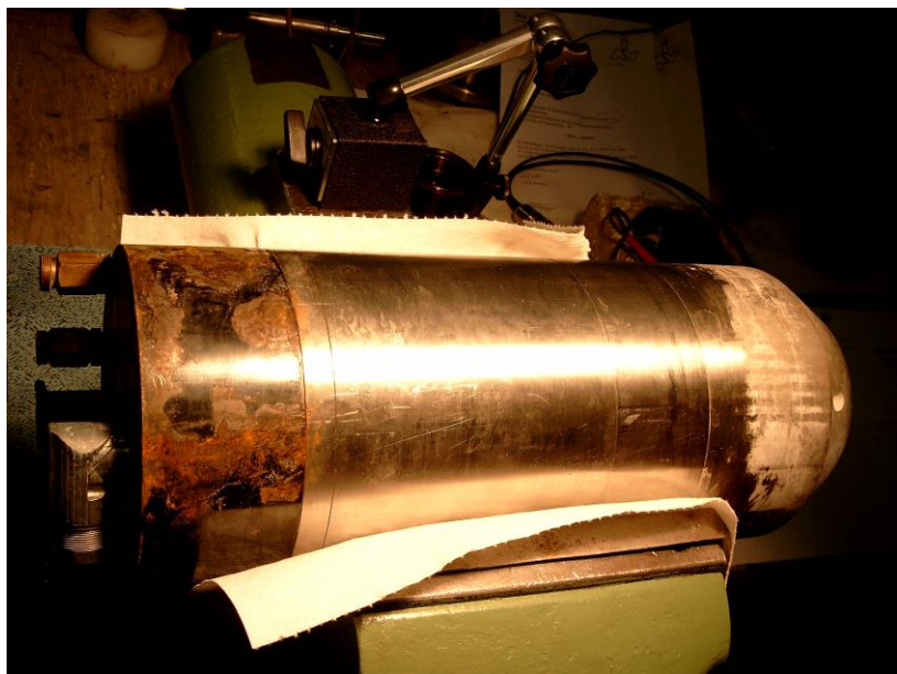
Werkzeugmaschinenspindel ungereinigt, UKF Universal-Kugellager-Fabrik, Berlin
