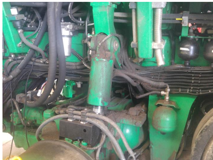
Hydraulikzylinder im Bereich Nutzfahrzeuge – kann mit Niederdruck-Heißreinigungsverfahren lokal gereinigt werden
