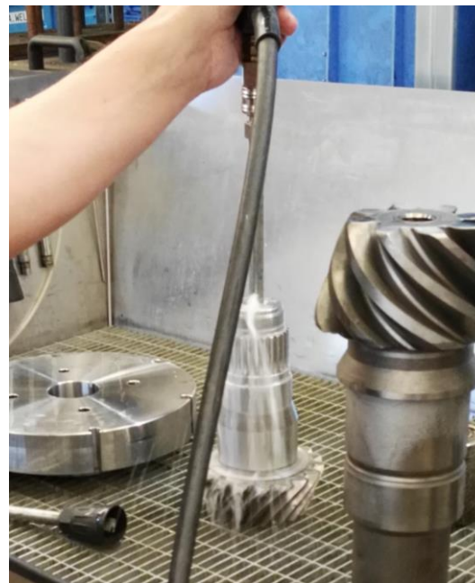
Innenreinigung eines Sacklochs in einer Welle - Detail
