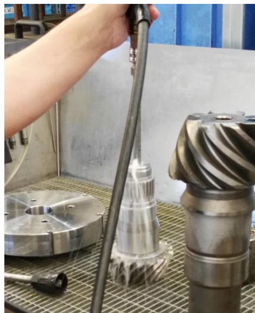
Händische Innenreinigung eines Sacklochs in einer Retarderwelle – der Prozessschritt kann auch automatisiert werden
