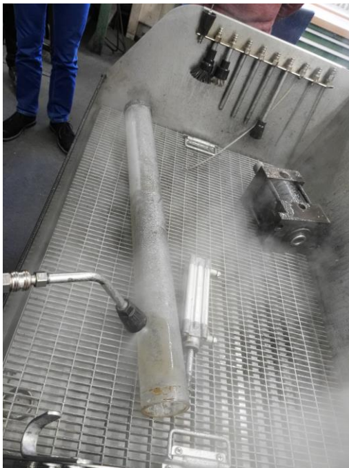
Außenreinigung eines stark verschmutzten Glasrohrs - vorher
