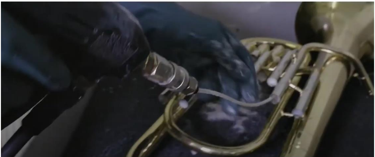
Rohrinnenreinigung am Beispiel einer Trompete – hier mit flexibler Düse
