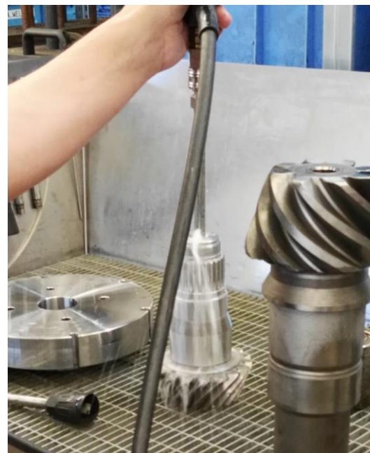
Innenreinigung eines tiefen Sacklochs in einer Welle - Detail
