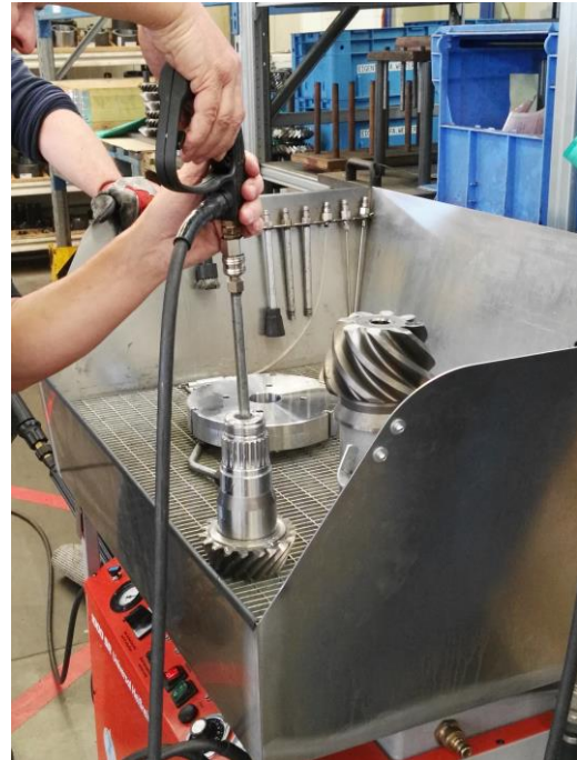
Innenreinigung eines tiefen Sacklochs in einer Welle
