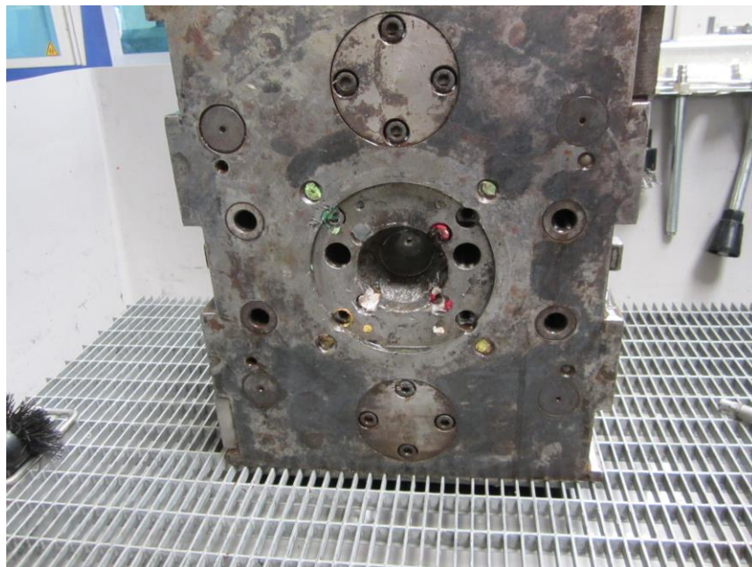
Kalibrierung - Werkzeug für die Extrusion – in Teilereinigungsebene eines 1000 SR
