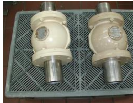
Ventile: rechts mit Mehlrückständen, links nach der Reinigung mit Niederdruck-Heißreinigungsverfahren
