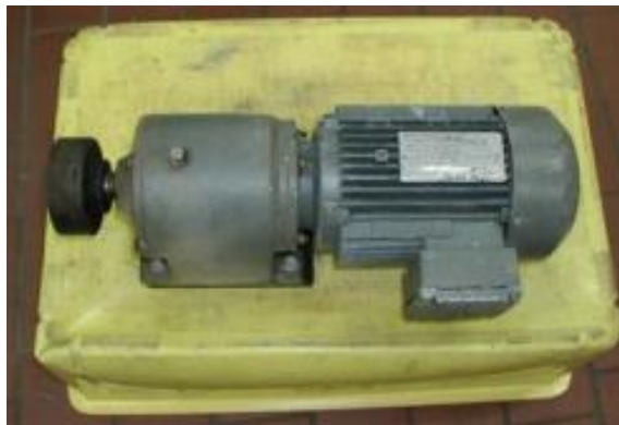
Antriebsmotor nach der Reinigung mit Niederdruck-Heißreinigungsverfahren
