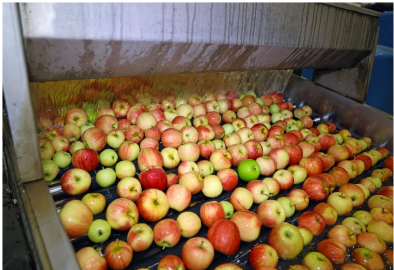
Fließband – Reinigung der Äpfel vor dem Keltern
