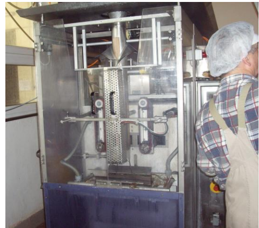
Verpackungsanlage in der Nudelproduktion ungereinigt
