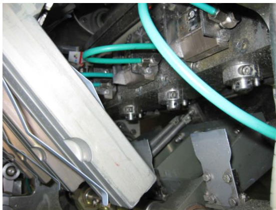
Verschiedene Details der Antriebssysteme (SIG Füllmaschinen): Händisch kaum zu reinigen, mit Niederdruck- Heißreinigung kein Problem
