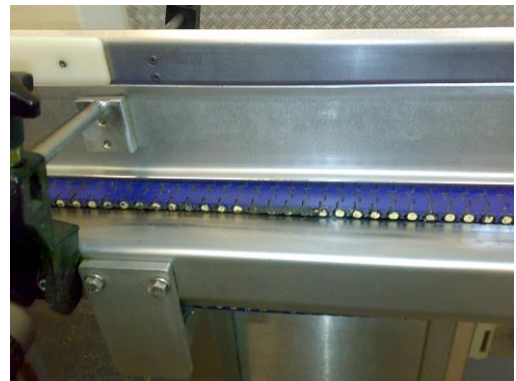
Förderband, Unterseite, mit fettigen Verschmutzungen, teilweise gereinigt
