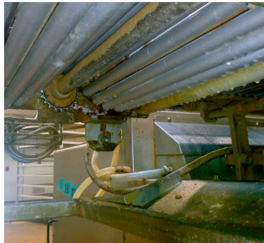
Förderband, Unterseite, mit fettigen Verschmutzungen, teilweise gereinigt
