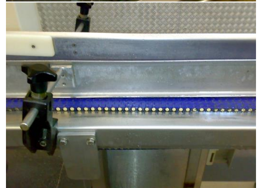
Abreinigen eines Förderbandes: Vorher, während und nach der Reinigung mit Niederdruck-Heißreinigungsverfahren
