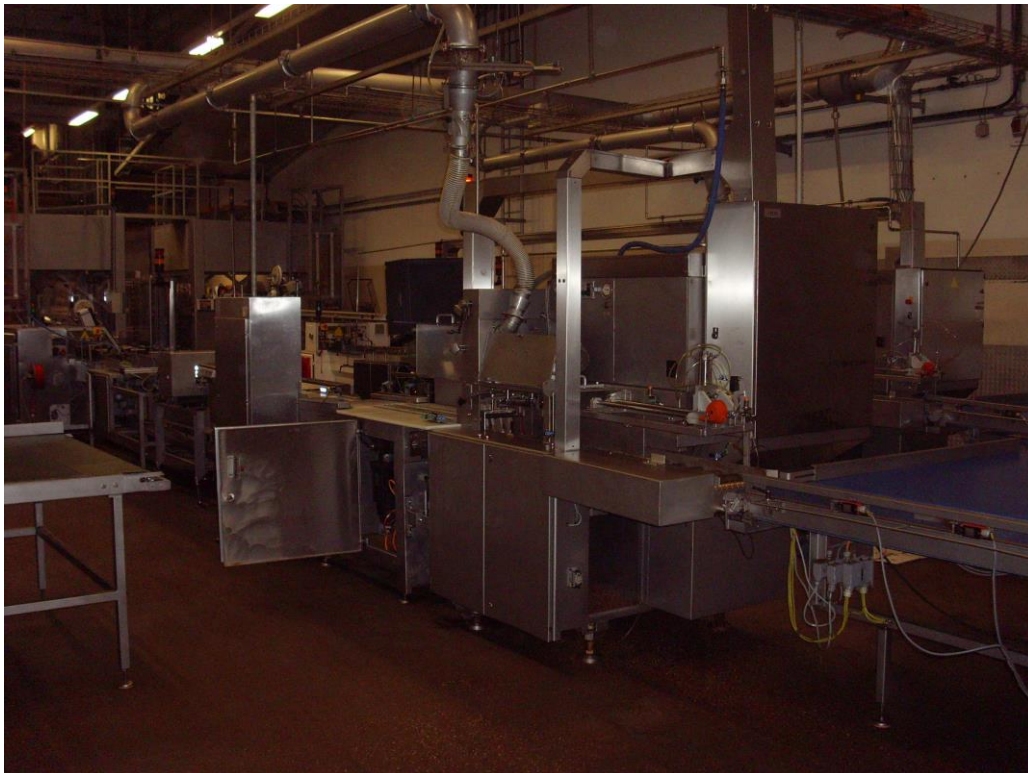
Brottschneid- und Packanlage für Schnittware: Belegt mit Speiseölen und Brotkrumen. Bisher gereinigt mit Druckluft und Lappen.
