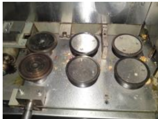
Maschinenteile mit Zucker- bzw. Karamell-Resten
