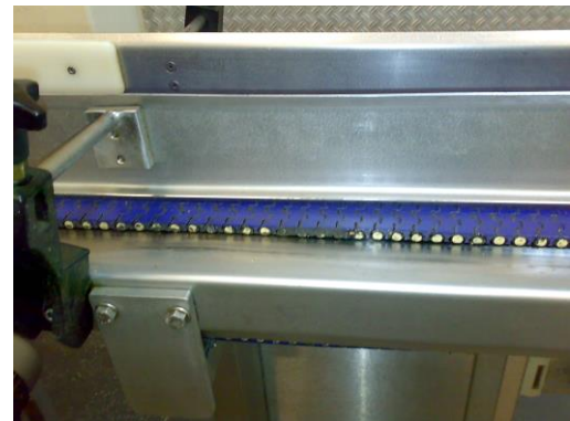
Förderband, Unterseite, mit fettigen Verschmutzungen, teilweise gereinigt
