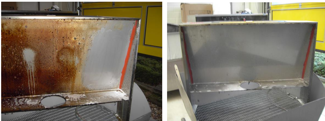
Reinigung von Brandschäden – während und nach der Reinigung in Teilereinigungsebene eines 1000 SR
