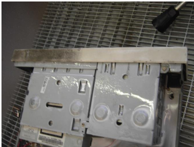
Schonende Reinigung von Festplatten mit geringen Brandschäden in Teilereinigungsebene eines 1000 SR
