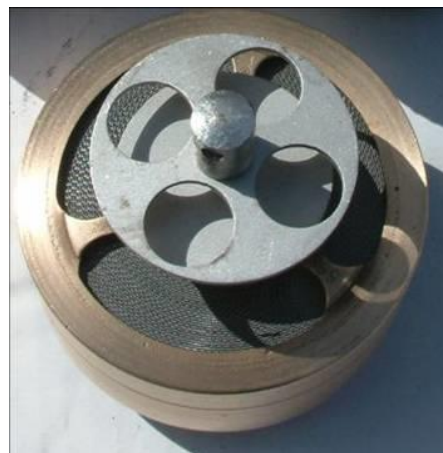
Rußfilter nach Reinigung und Polieren des Messingkäfigs mit Polierleinen
