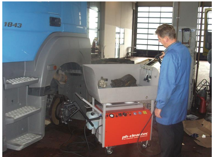
Teilereinigung direkt am Fahrzeug reduziert teure Wegezeiten
