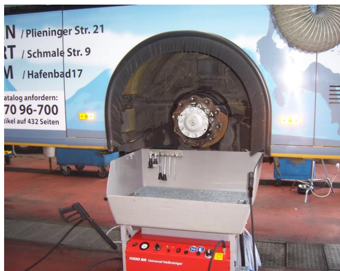
Bremsenreinigung direkt an der Hebebühne - Bus des Öffentlichen Personen-Nahverkehrs (ÖPNV)
