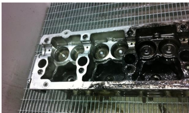
Zylinderkopf (Smart) – links nach wenigen Sekunden, rechts ungereinigt.
