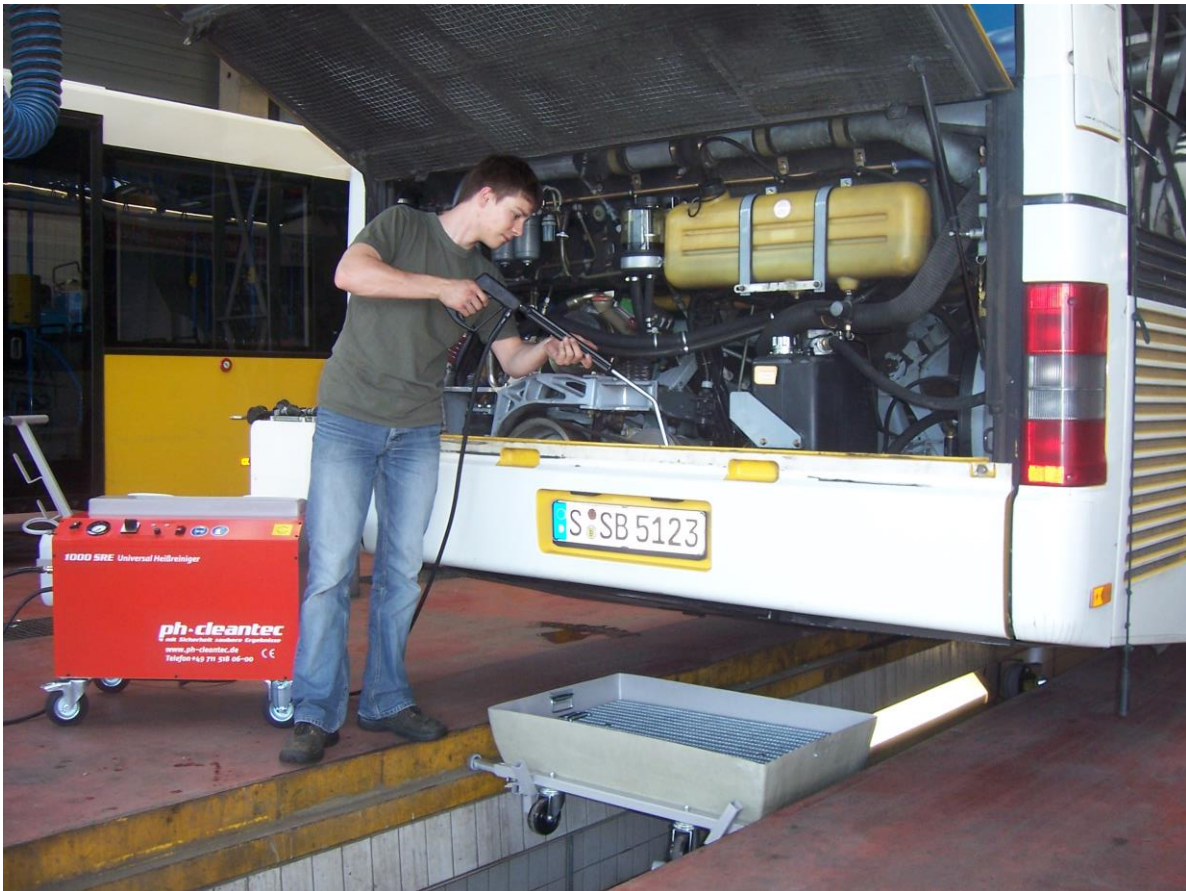
Reinigung des Motorraums an einem Bus des Öffentlichen Personen-Nahverkehrs (ÖPNV) mit Niederdruck-Heißreinigungsverfahren über der Grube – auch ohne Ausbau problemlos und vor allem schnell und effizient. Schmutzwasser wird mit einer KW-Wanne aufgefangen und kann recycled werden.
