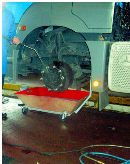
Bremsenreinigung an der Grube – LKW mit Auffangwanne
