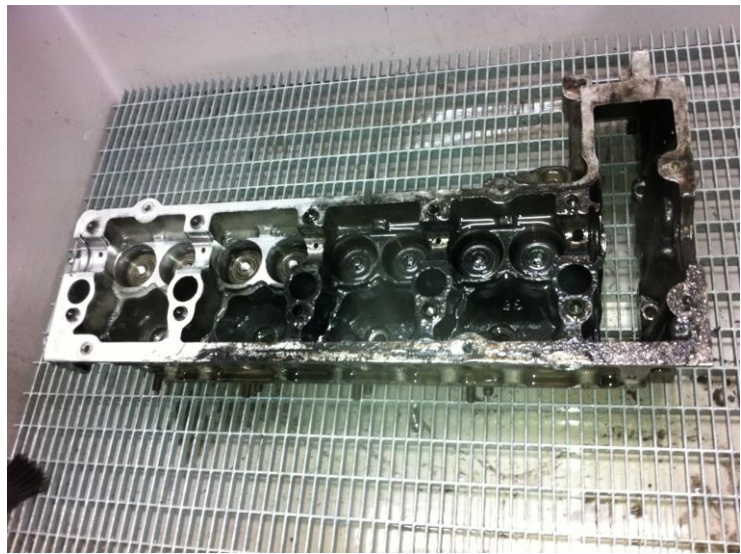
Teilereinigung, hier der Zylinderkopf eines Smart. Links in wenigen Sekunden gereinigt, rechts ungereinigt.
