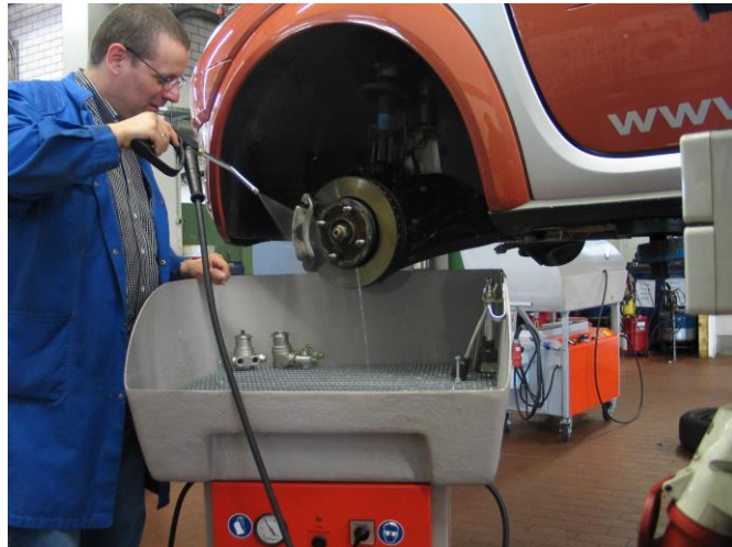
PKW-Bremsenreinigung direkt an der Hebebühne spart Aus- und Wiedereinbau-Zeiten, außerdem Wegezeiten. Schmutzwasser wird im Gerät aufgefangen und recycled .
